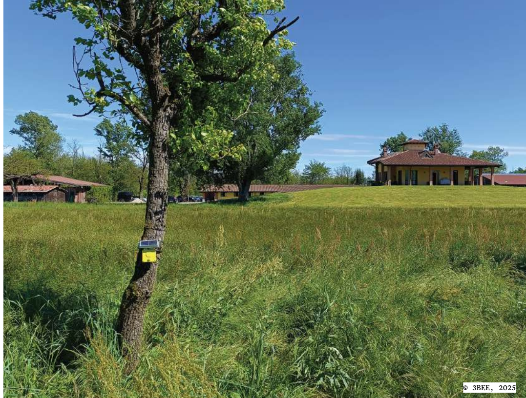
Spectrum, sensore bioacustico IoT sviluppato da 3Bee per il monitoraggio degli apoidei e sirfidi.
