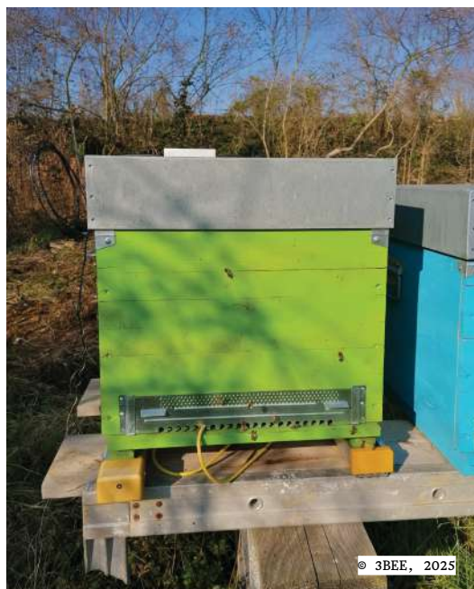
Hive-Tech, sensore IoT sviluppato da 3Bee, posizionato sotto l'arnia per il monitoraggio dell'attività delle api mellifere
